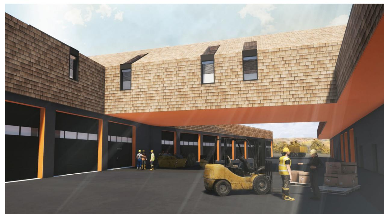
Hallen auf und bildet somit eine Art Brücke, welche sie miteinander verbindet. Mit Ausnahme der Treppenhäuser und Liftschächten handelt es sich um eine reine Holzkonstruktion. Lediglich der Brückenbereich wird durch eine Stahlstruktur verstärkt. Die Wände und Stützen des Erdgeschosses sind in Stahlbetonkonstruktion vorgesehen.
